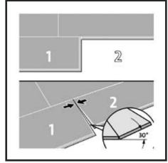
Ab der zweiten Dielenreihe: Setzen Sie zunächst die Längsseite der verlegenden Diele im Winkel von 30° an die Nutseite der verlegten Diele an. Drehen Sie das Profil ein und schieben die Diele angewinkelt an die Kopfkante.
