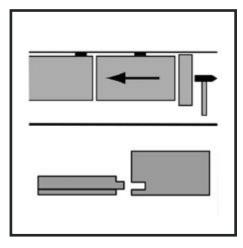
Setzen Sie die neue Diele bündig an die Stirnseite der zuvor verlegten Diele. Die Nut & Feder Verbindung an der Kopfkante wird vorsichtig einschlagend mit Hammer und Schlagklotz verbunden.
